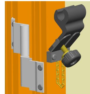
**ATTENZIONE** in caso di montaggio del ferma-anta MAGIC-BLOCK in zone notoriamente spazzate da venti molto forti, è consigliabile, aggiungere una terza cerniera all'anta in una posizione di mezzeria rispetto alle esistenti e, il montaggio di due ferma-anta MAGIC-BLOCK sulla stessa anta, da montare uno sulla cerniera inferiore e uno sulla cerniera di mezzeria. È buona norma, comunque, chiudere la finestra in caso di vento forte.
